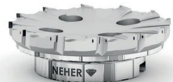
Der luftgekühlte Aufsteckfräser Ø125 besitzt speziell geformte Kühlkanäle zur Stabilisierung des Luftstroms. Zudem verfügt der Fräser über Austritte im Spanraum, neben und hinter der Schneide.
