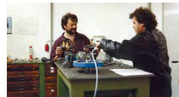
► PKD Poliermaschine (selbstkonstruierter Eigenbau)
